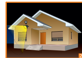
Cuando no hay suficiente luz ambiental, el sensor se activa conectando la carga.
